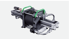
单驱双作用 单驱动活塞，每个工作循环实现两次增压，较相同压力比的单驱单作用流量更大。
