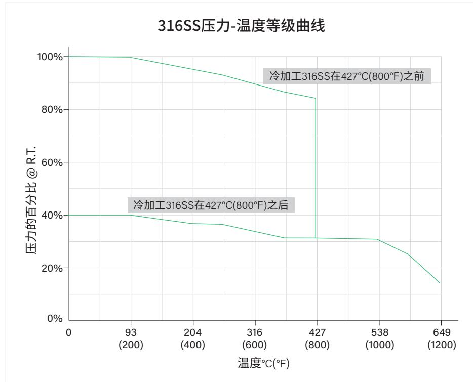
注:1.此处呈现的曲线仅供参考使用,可能因其他零件材料的压力-温度特性而产生显著影响。若有特殊的压力、温度要求,请咨询工厂以获取推荐的阀体材料和密封件。
