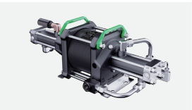
单驱二级 单驱动活塞, 每个工作循环实现两个级别的增压, 较相同压力比的单驱双作用能对更低压力的气体实现增压。
