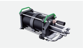
双驱单作用 双驱动活塞, 每个工作循环实现一次增压, 较相同压力比的单驱单作用流量更大, 压缩空气能耗也更高。
